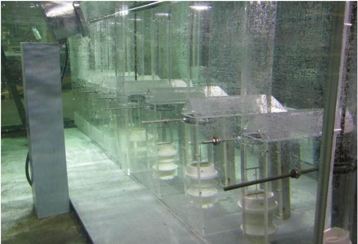
**Figura 6 - Bancada dos ensaios hidráulicos de modelo reduzido do poço de sucção das Bombas de Baixa Carga – Laboratórios da KSB - Alemanha**
