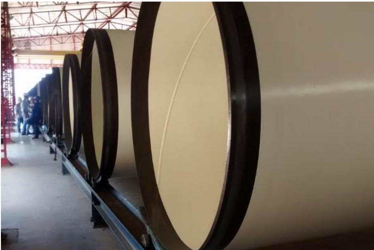
Figura 8 - Tubos Helicoidais API 5L PSL1 X65 - 2100mm e espessura de 15,875mm prontos para inspeção
