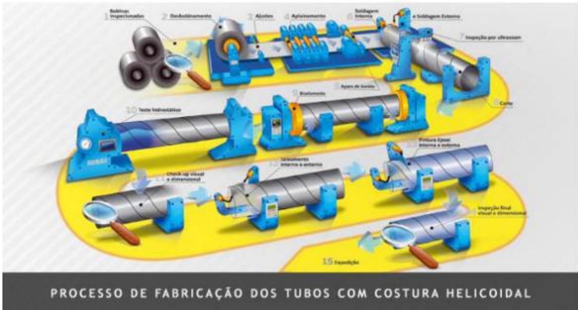
Figura 7 – Processo de Fabricação dos Tubos Helicoidais API 5L PSL1 X65 - 2100mm e espessura de 15,875mm
