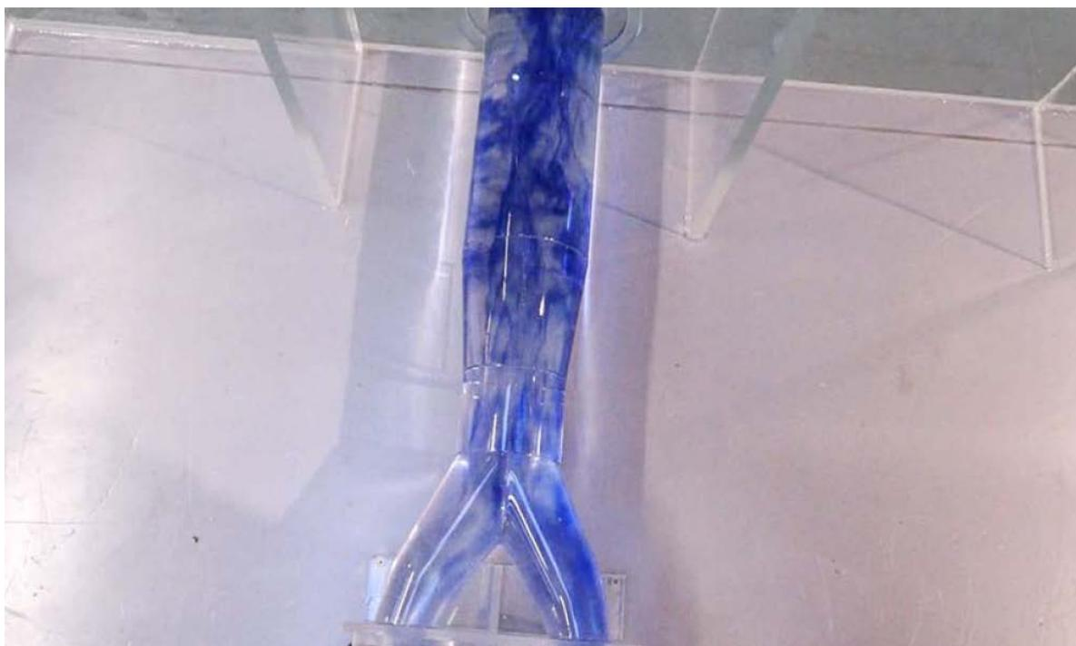
**Figura 4 – Detalhe da distribuição uniforme na sucção das Bombas de Alta Carga - Bancada dos ensaios hidráulicos de modelo reduzido**
