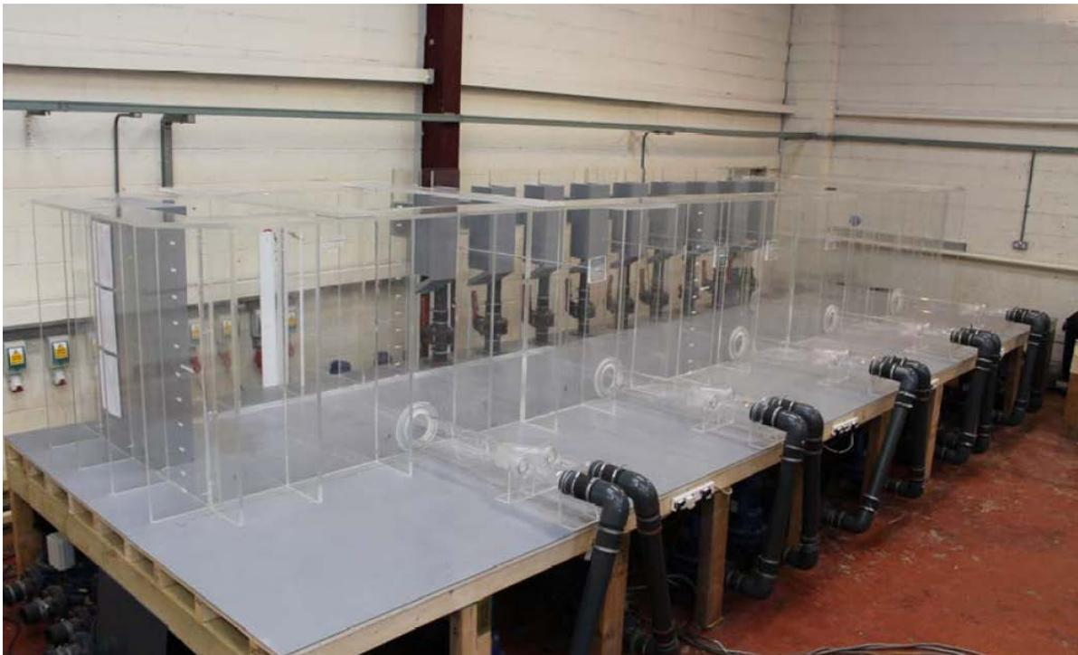
Figura 3 - Bancada dos ensaios hidráulicos de modelo reduzido do poço de sucção das Bombas de Alta Carga – Hydrotec - Leeds Inglaterra.
