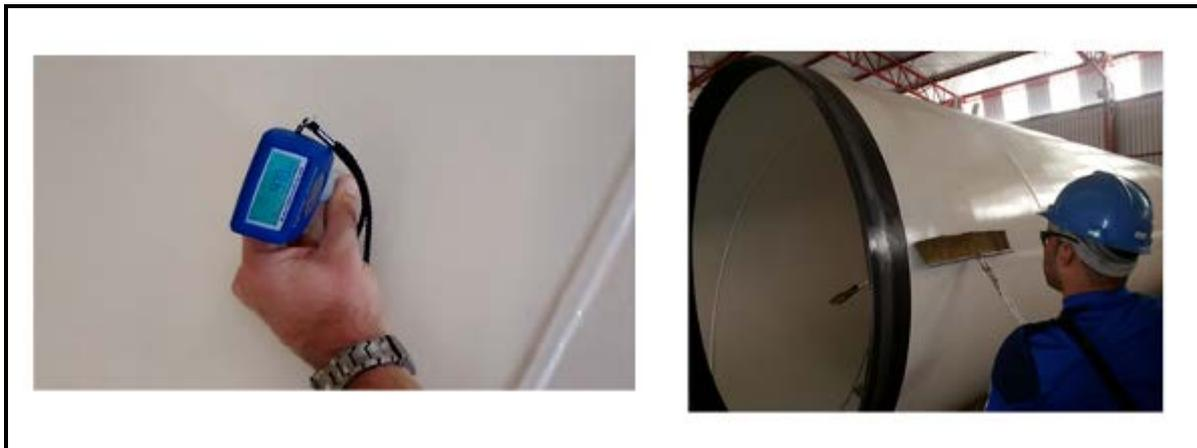
Figura 24 – Verificação dos revestimentos interno e externo por meio de medição de espessura de película de tinta seca e pelo método Holiday-Detector.
