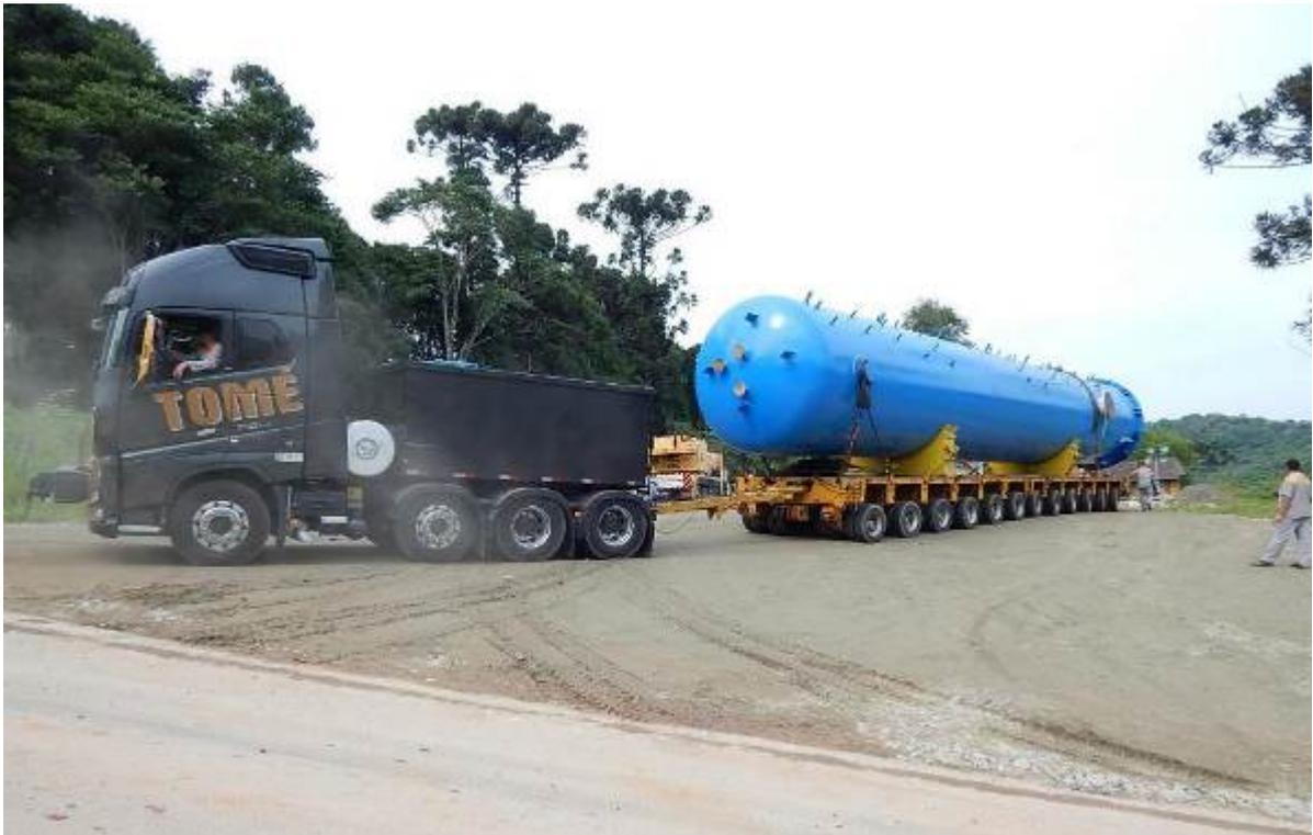
Figura 19 – Detalhe da linha de eixos e truck de tração para transporte dos RHOs.
