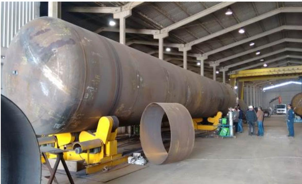
**Figura 13 - Acompanhamento tecnológico das juntas soldadas e insumos utilizados, onde verifica-se nesta foto a soldagem das virolas e dos tampos para composição do corpo dos RHs.**
