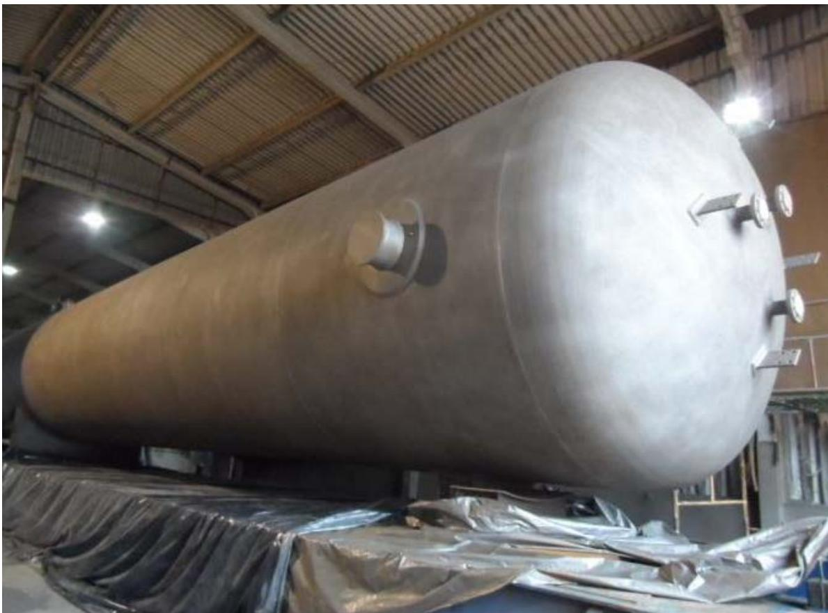
**Figura 16 – Processo de jateamento e preparação para pintura**
