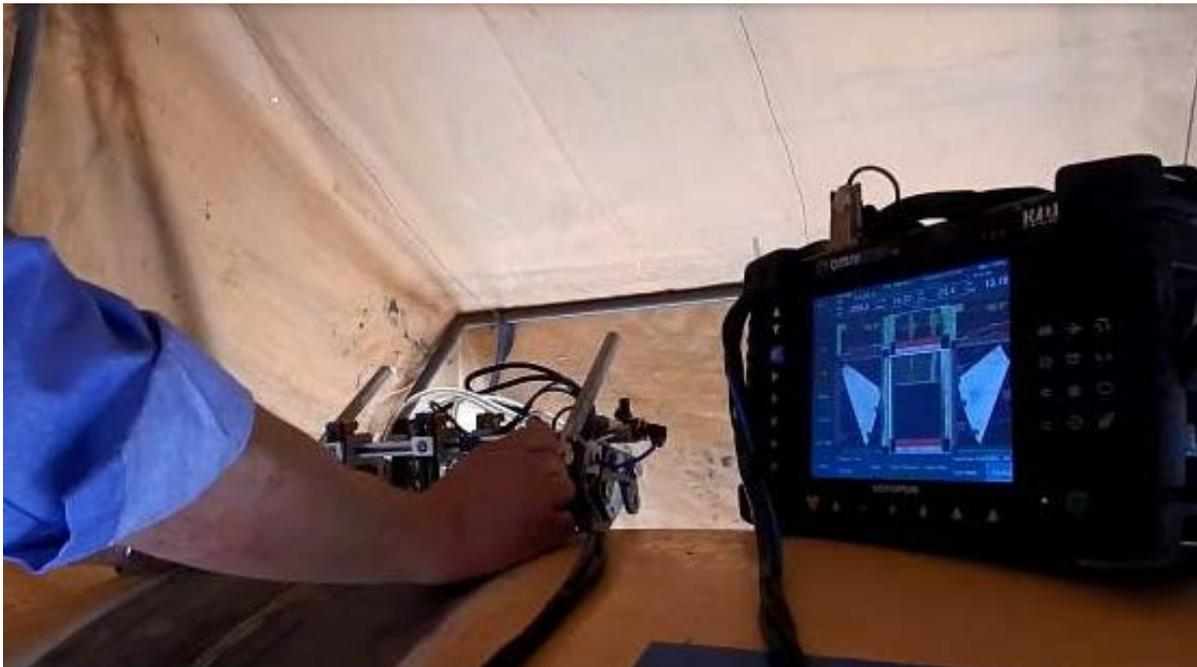
Figura 23 – Detalhe da realização de ensaio de ultrassom automatizado Phased- Array e TOFD na junta soldada.
