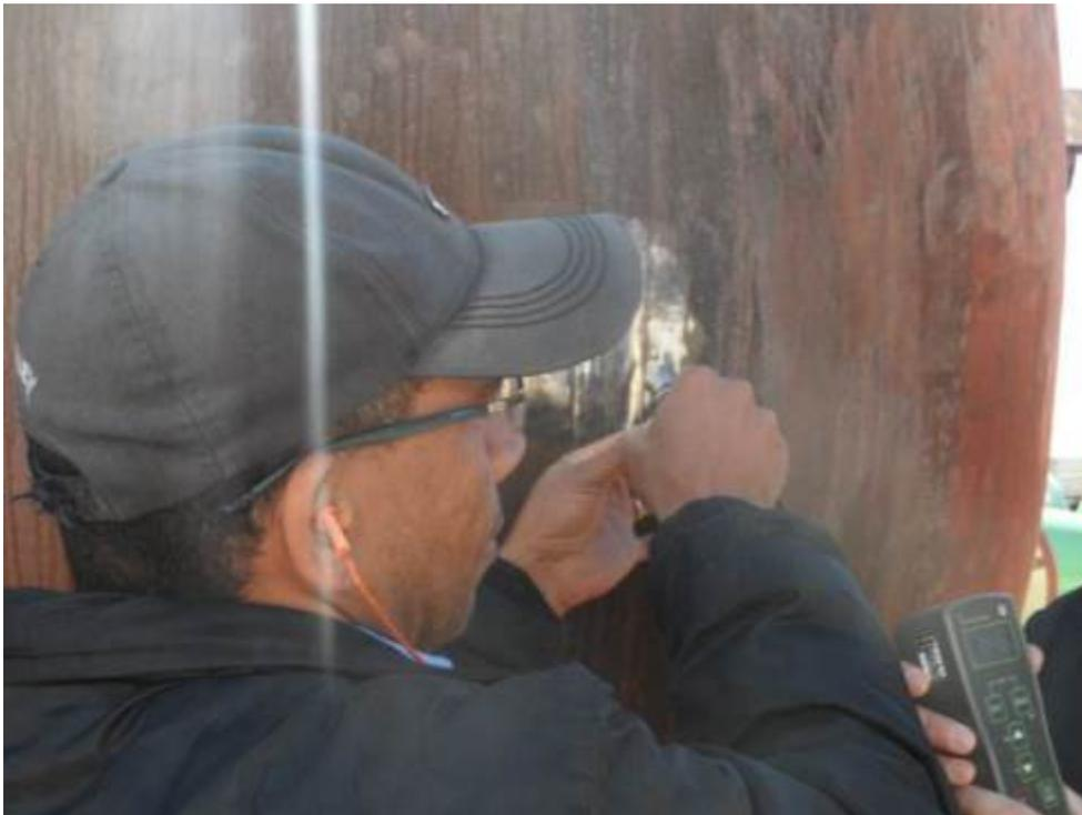
**Figura 15 – Após o tratamento térmico são realizados os ensaios de dureza nos pontos de solda para verificação da eficácia do tratamento aplicado.**
